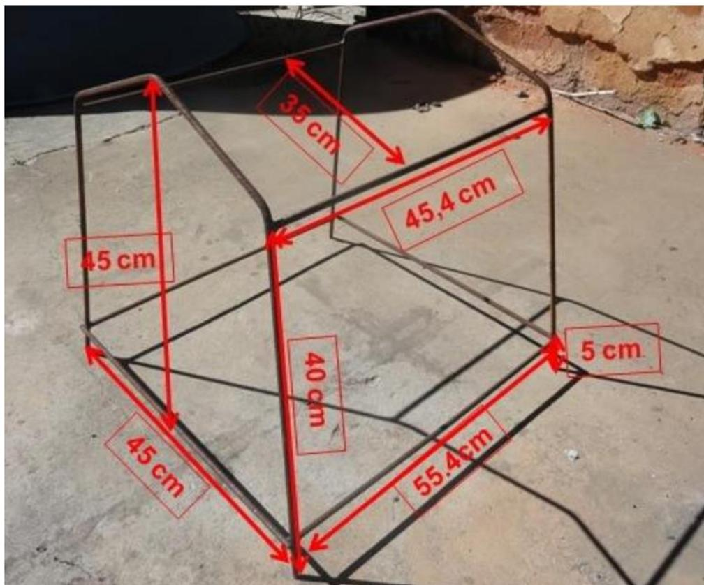
Foto – Itens 5 e 6 (Suporte metálico (caveleto) para colmeia padrão Langstroth) com medidas referenciais.
