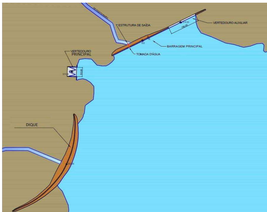
Figura 3 - Arranjo da Barragem Poço do Magro.
