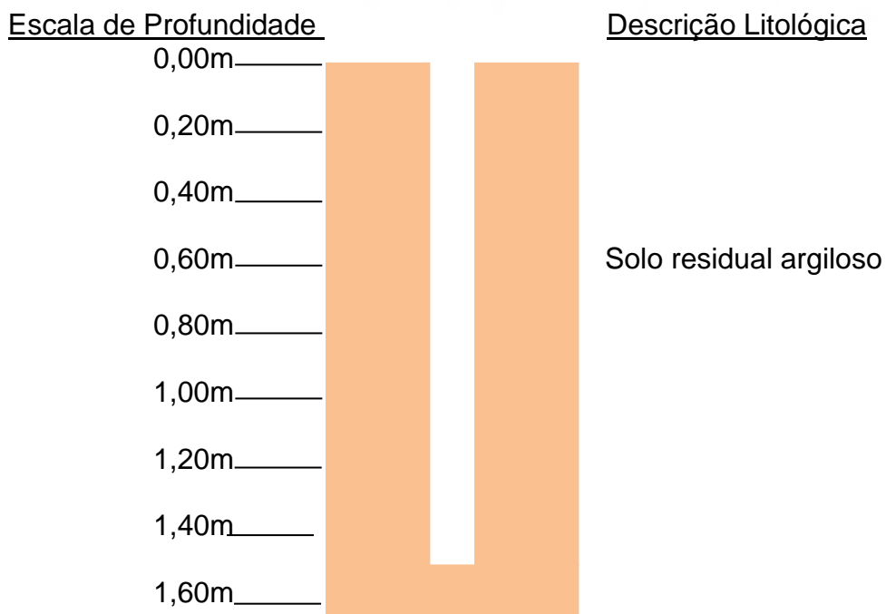
Fig. 11: Perfil Geológico esquemático em ST 11 com Profundidade Final 1,50m.
