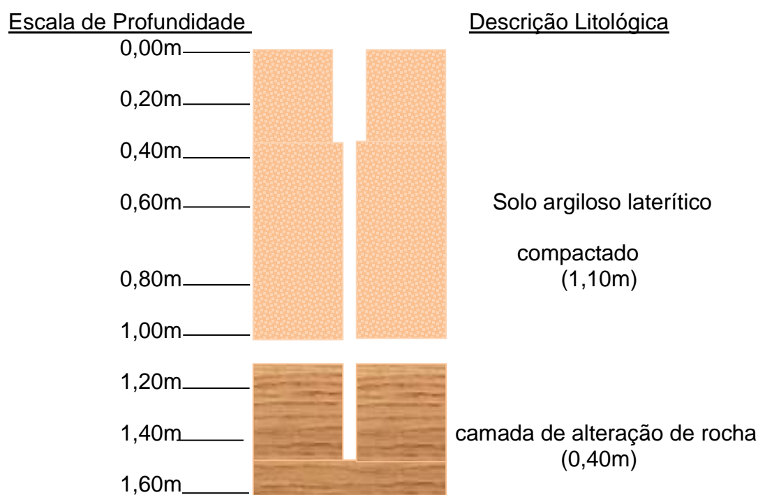
Fig. 05: Perfil Geológico esquemático em SP 05 com Profundidade Final 1,45m.
