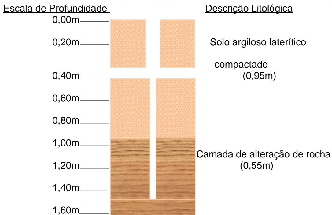
Fig. 29: Perfil Geológico esquemático em ST 29 com Profundidade Final 1,50m.
