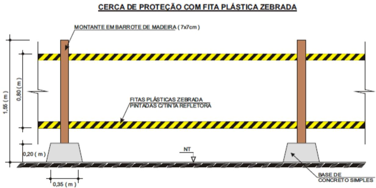
Figura 4 – Esquema de cerca de proteção com fita zebraada.
