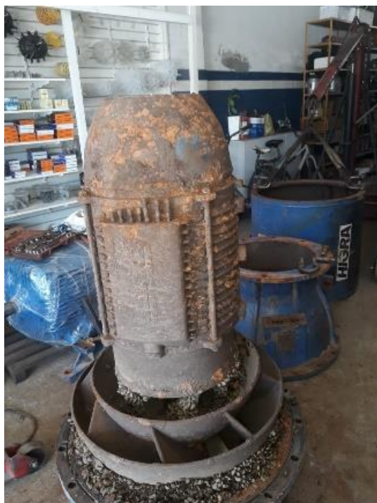
Eletrobomba impregnada de crustáceos
