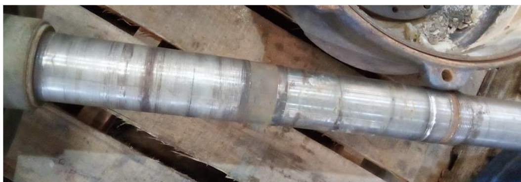
Eixo com desgaste abrasivo devido à areia em suspensão no líquido bombeado
