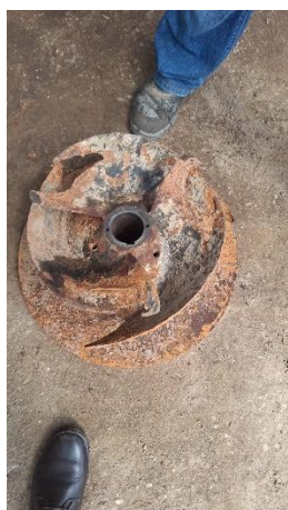
Rotor desgastada por erosão
