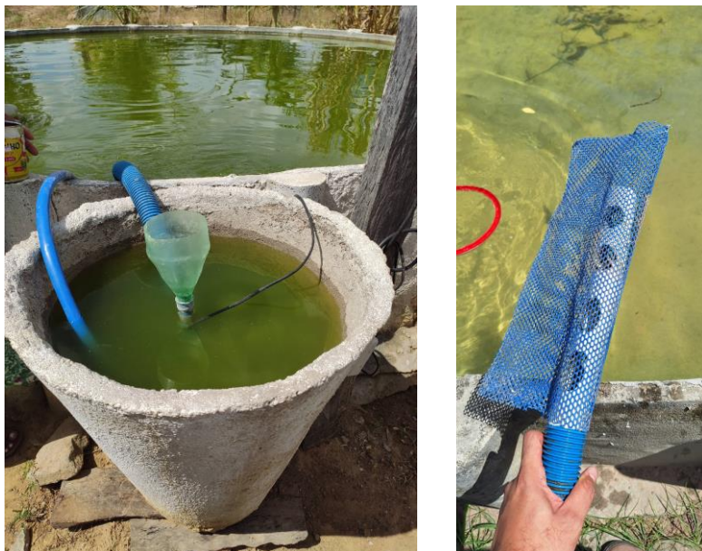
Figura 13: Demonstração do sedimentador e tela para o sifão Fonte: CODEVASF.
