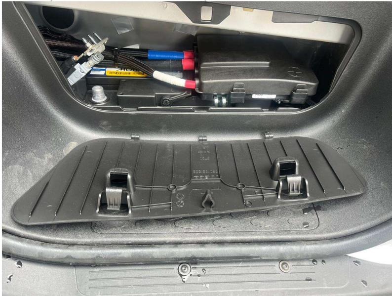
Após abertura, já se tem o acesso a chave que fica no polo negativo da bateria, lado esquerdo, ao qual pode ser desconectada, como mostrado na figura acima.
