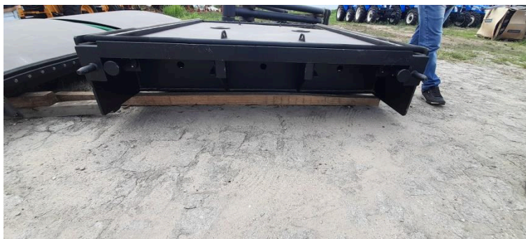
Figura 6 – Painel stoplog armazenado no galpão da Superintendência. Uso permitido mediante compatibilidade dimensional.
