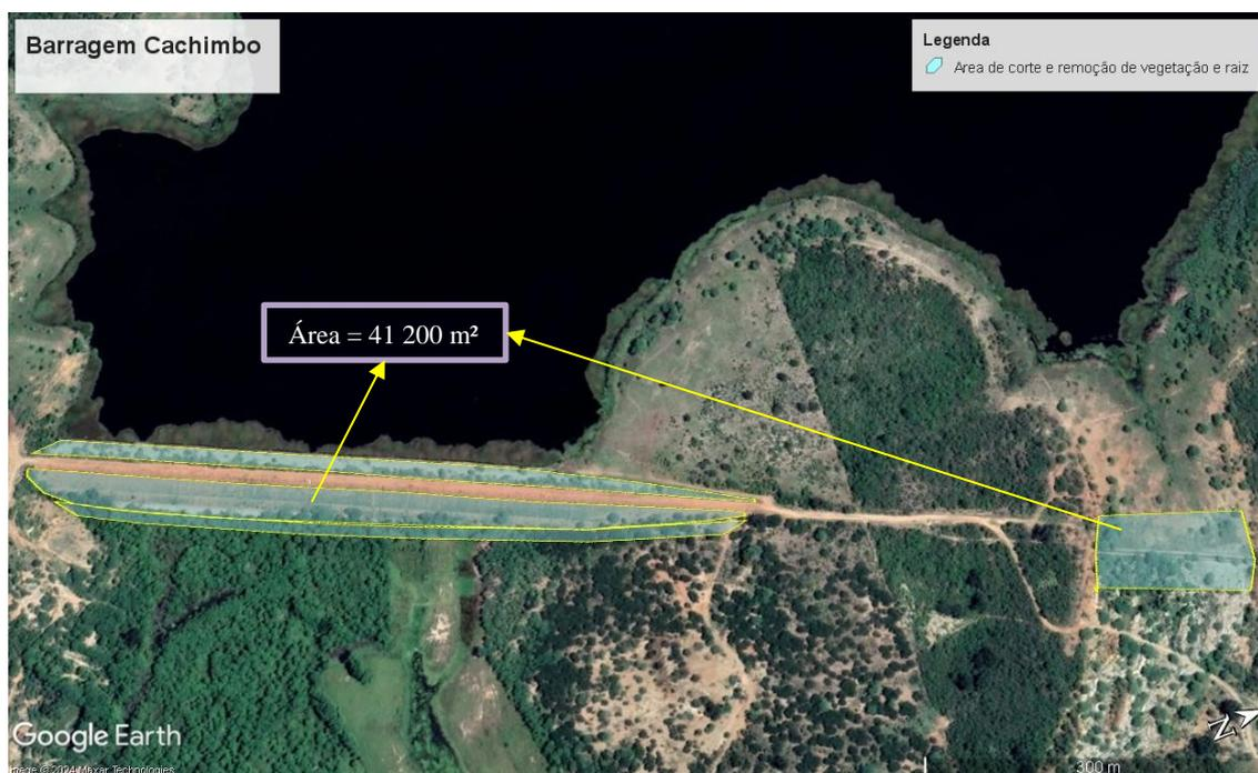
Figura 1 – Vista superior da Barragem Cachimbo com o talude de montante, talude de jusante, área a jusante e parte do canal de aproximação/restituição demarcada.
