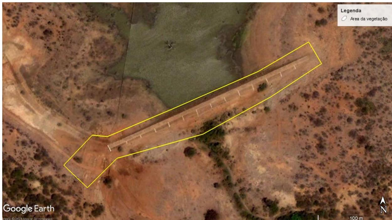
**Figura 1 – Vista superior da Barragem Angico com indicação da área a ser realizada limpeza de vegetação: talude de montante, crista, talude de jusante, região a jusante e parte do canal de aproximação/restituição demarcada.**
