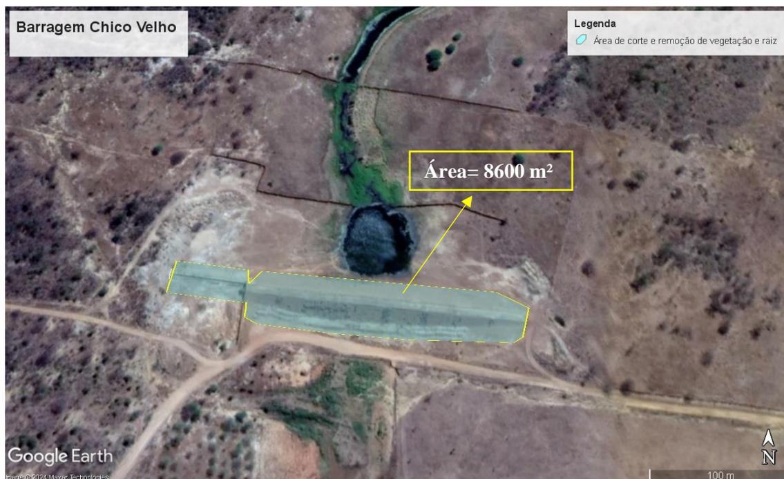
**Figura 1 – Vista superior da Barragem Chico Velho com a crista, talude de montante, talude de jusante, área a jusante e parte do canal de aproximação/restituição demarcada.**
