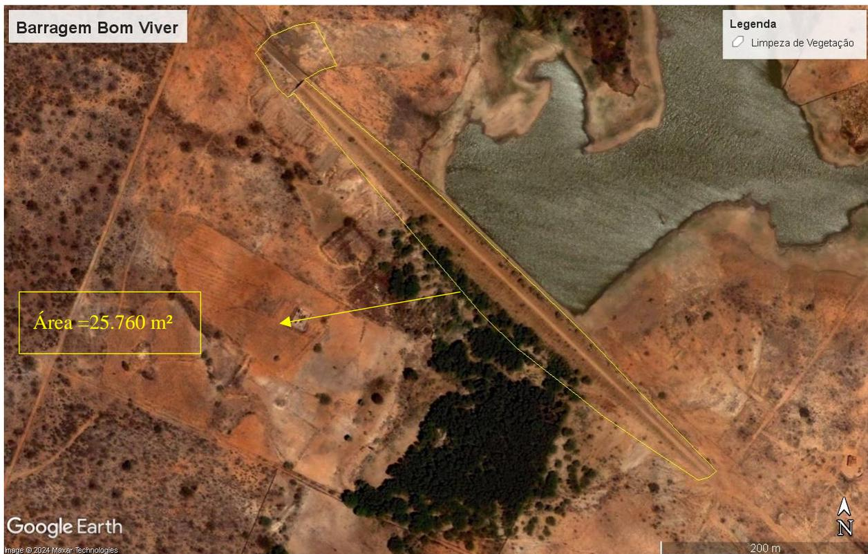
**Figura 1 – Vista superior da Barragem Bom Viver com o talude de montante, talude de jusante, área a jusante e canal de aproximação e de restituição demarcada.**
