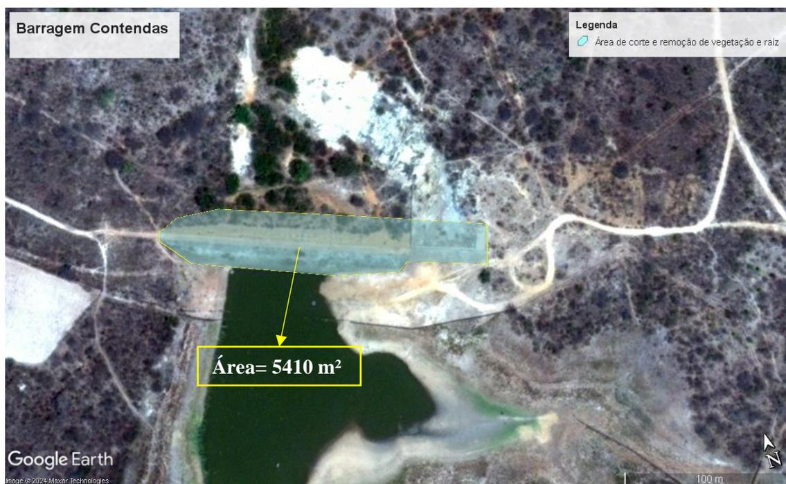
**Figura 1 – Vista superior da Barragem Contendas com a crista, talude de montante, talude de jusante, área a jusante e parte do canal de aproximação/restituição demarcada.**
