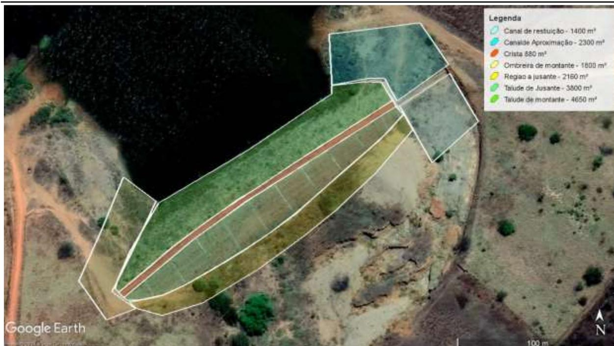
**Figura 1 – Vista superior da Barragem com indicação da área a ser realizada limpeza de vegetação: talude de montante, crista, talude de jusante, ombreira, região a jusante e parte do canal de aproximação/restituição demarcada.**
